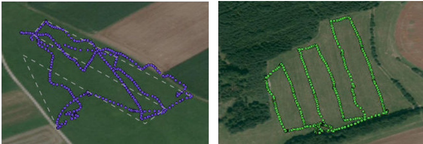
Abb. 3.9: Links: UAV Positionen eines manuellen Fluges beim Versuch systematisch Streifen zu fliegen. Rechts: wegpunktbasierter Flug. Quelle Luftbilder: DOP 200, Bayerische Vermessungsverwaltung.
