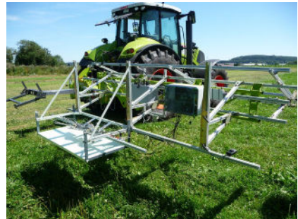
Abb. 2.5: Der mähwerkgekoppelte Wildretter. Die Sensoren sind so angeordnet, dass sie jeweils in die nächste Mähspur ragen, sodass gleichzeitig gesucht und gemäht werden kann (Quelle der Skizze links: Fa. Claas).
