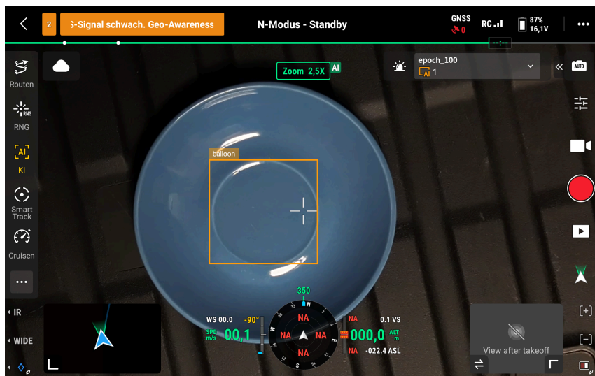
Abb.: Eine Untertasse wird fälschlicherweise als Ballon klassifiziert.
